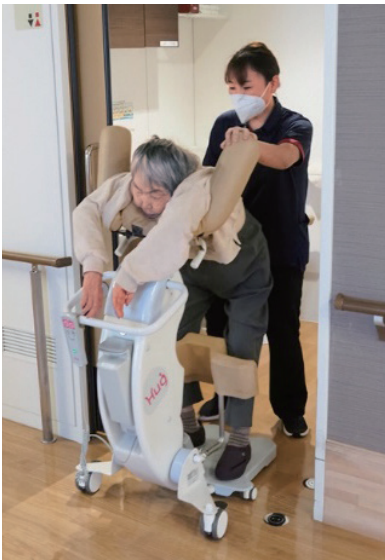
①トイレの出入りがしやすいコンパクト設計。移動中、利用者は立位を保持
